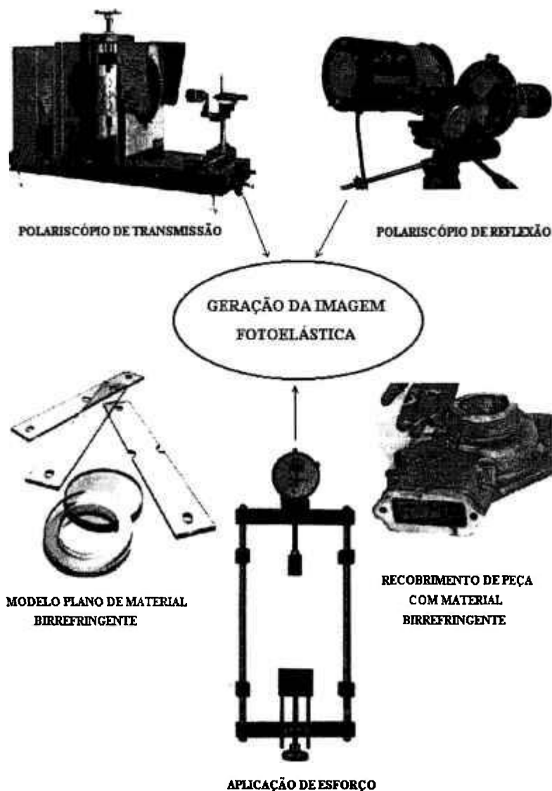
Figura 4 - Equipamentos e materiais envolvidos na geração de imagens fotoelásticas (1-4) .
