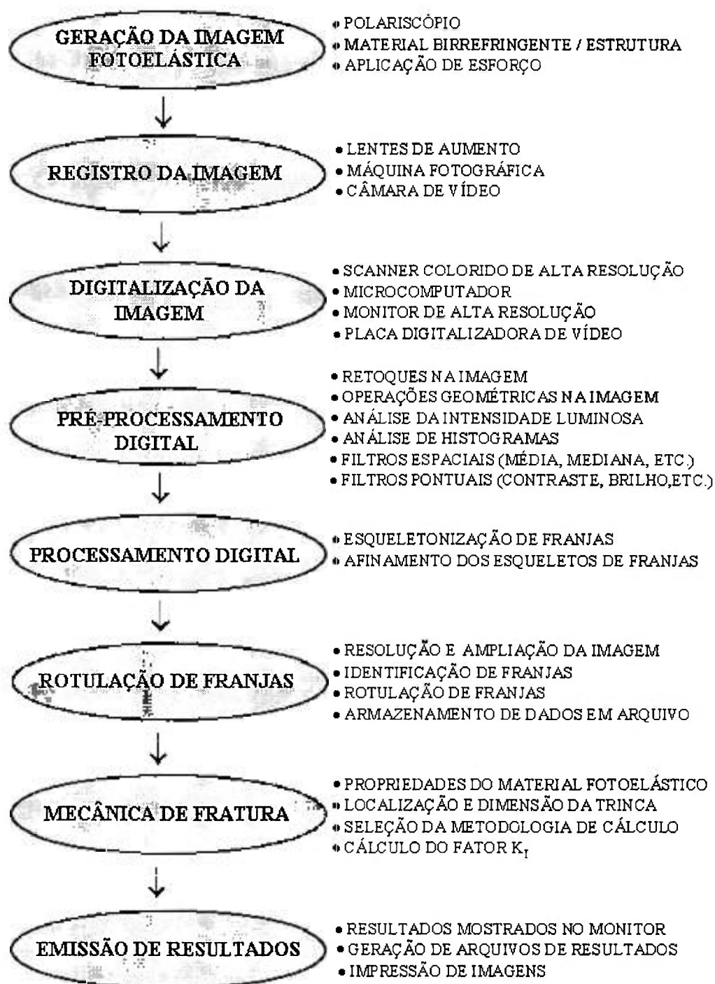
Figura 59 - Esquema global das etapas relacionadas com a utilização do sistema FOTOEL.
